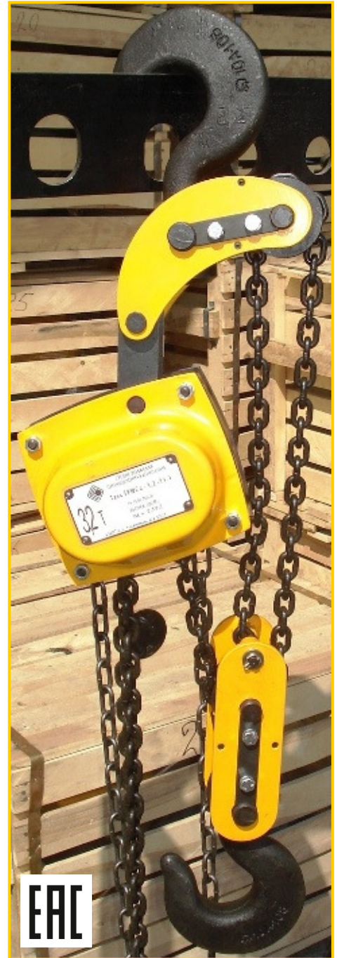
Таль стационарная ТРШСп-3,2 грузоподъемностью 3,2 тонны
