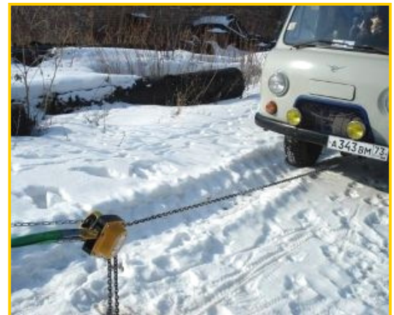
Пример использования тали ТРШСп-1,0 в качестве лебедки
