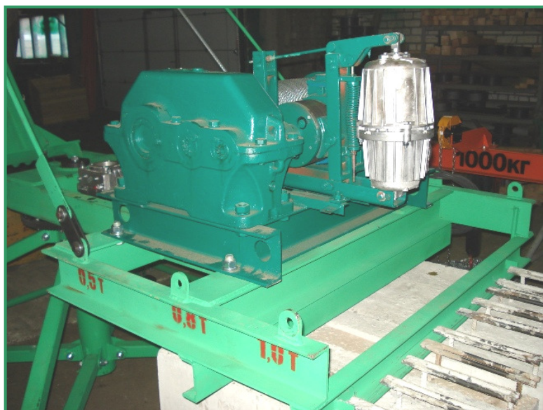
Мотор-редуктор механизма поворота служит для вращения поворотной части крана
