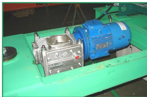
Мотор-редуктор механизма поворота служит для вращения поворотной части крана
