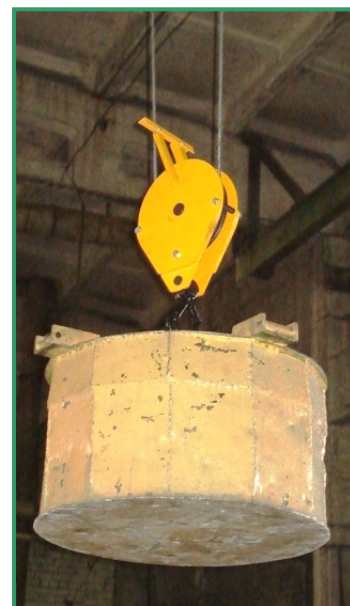
Подвеска крюковая крана КСП-1000 МАСТЕР-3 при проведении испытаний крана.
