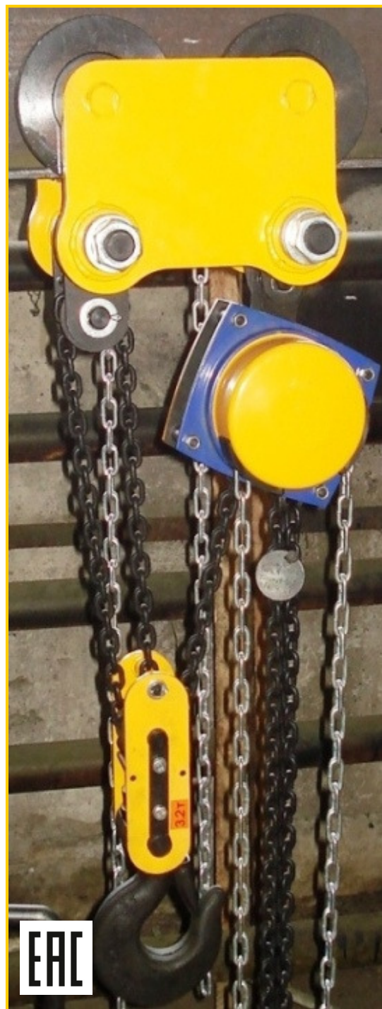
Таль передвижная ТРШБп-3,2 грузоподъемностью 3,2 тонны
