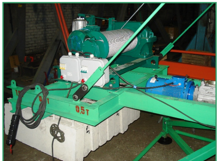
Грузовая лебедка – служит для подъема/опускания груза и используется при монтаже/демонтаже крана
