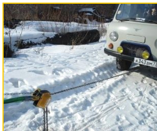
Пример использования тали ТРШСп-1,0 в качестве лебедки
